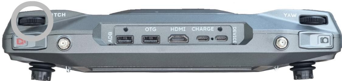
Der linke Drehregler steuert die Neigungsachse des Gimbal.
