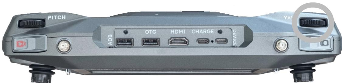
Der rechte Drehregler steuert die Gimbal-Y-Achse.
